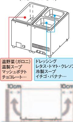
※ビルトインの場合には、吸気 (底部) に10cm角以上の開口を設けてください。
