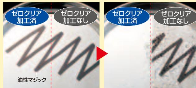
ステンレス丸盆にゼロクリア加工済及び加工なし面を用意し、油性マジックで汚れをつけ、水をかけます。スポンジタワシの使用により水のみで洗浄でゼロクリア加工済面の汚れを浮かせ落とし、きれいにします。
