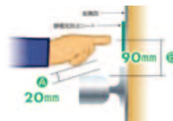
ラベル接触前の放電衝撃を防ぐため、上図中A (ラベル接触時の身体とドアノブ等金属部の距離) は約20mm以上必要です。 B (ラベル中心からドアノブ上端までの距離) を約90mm以上に設定することが目安です。
