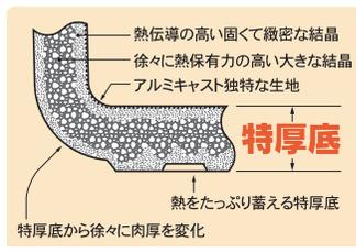
アルミキャスト<鑄造>製厚手調理器結晶組織が熱をたっぷり蓄えて冷めにくく、熱の保有力が大きいので、適温になれば、中火・弱火で十分！
