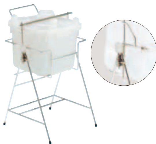
⑧ 角度固定式 ステンレス 缶スタンド ASK-14 (バッグインコンテナーBIC#20専用) 〈BKV-70〉目 7-1455-0801 ¥50,800 405×400×H725(水平395) 有効内寸:335×330×H295(320) ●注入角度は30°・60°・90°・120°・ 150°と5段階に変更できます。 ※写真のバッグインコンテナーは別売りです。
