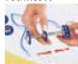
ローラー幅を写真のように15mm~123mm(15mm間隔)まで調節できます。
