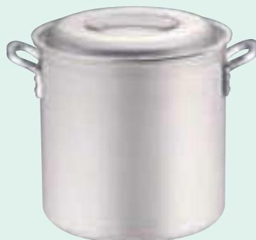
熱伝導に優れたアルミの特長はそのまま電磁調理器対応になりました。秘密は底面に貼られたステンレスディスク。ディスクが電磁調理器にすばやく反応して、底面からの熱をスムーズに鍋の側面に伝えますので鍋全体でムラなく加熱します。電磁調理器はもちろん、ガス火など幅広い熱源に対応します。洗浄・保管などの取扱いは従来のアルミ鍋と変わりませんので、長年アルミ鍋を愛用された方でも、同様の使い方ができますので安心です。
