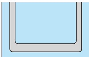
●耐蝕性に優れた新素材 SUS444 (18クロームモリブデン鋼)を使用し、鍋底は2~3mmの単層極厚構造です。業務用電磁調理器に最適です。
